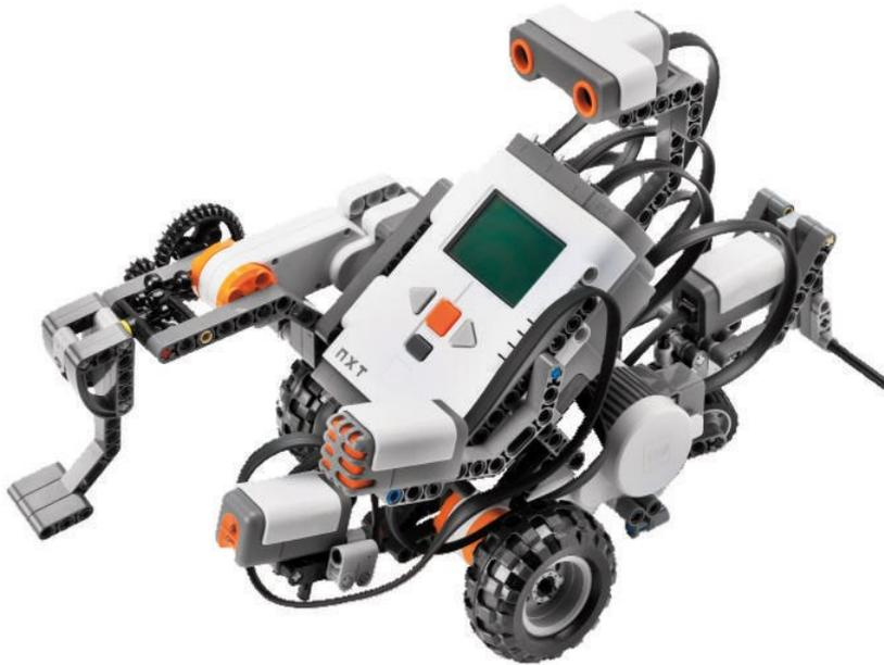
« *Golf-bot* » Modèle de base. Nous avons monté le même, le bras en moins, et le capteur de luminosité dirigé plus vers le bas.
