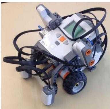
Dans cette phase, le robot ne doit scanner aucune cellule. On peut donc se passer du capteur de distance orienté vers l'avant et donc enlever le système de rotation. On conserve quand même un capteur de chaque côté pour pouvoir détecter si le robot est trop proche d'un mur.
